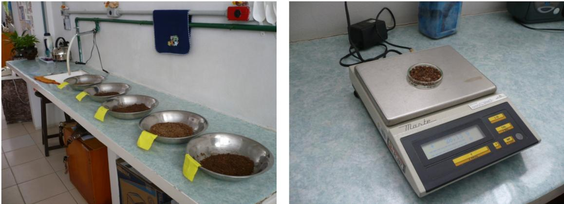
**Figura 25** – Procedimento de análise granulométrica.
